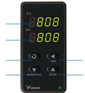
设置参数方法：当参数锁未锁上时，按 键并保持约 2 秒钟，等显示出参数后再放开。再按 键，仪表将依次显示各参数，如回路 1 输入规格 InP1、参数锁 Loc 等等。对配置好并锁上参数锁的仪表，按 键即可显示参数 (无需保持 2 秒)，只出现操作工需要用的参数 (现场参数)。通过 、、 键可修改参数值。先按 键再按 键可退出设置参数状态，按 键保持不放可返回检查上一参数。
